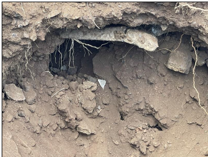
Figura 13 – Um dos vazios observados no P6, resultante da deposição de entulho.
