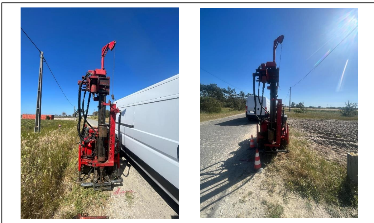
Figura 6 – Fotografias obtidas dos locais dos ensaios de DPSH5 (EE4) e DPSH6 (EE4) (da esquerda para a direita), aquando da execução dos trabalhos de campo (23-04-2024 e 24-04-2024).
