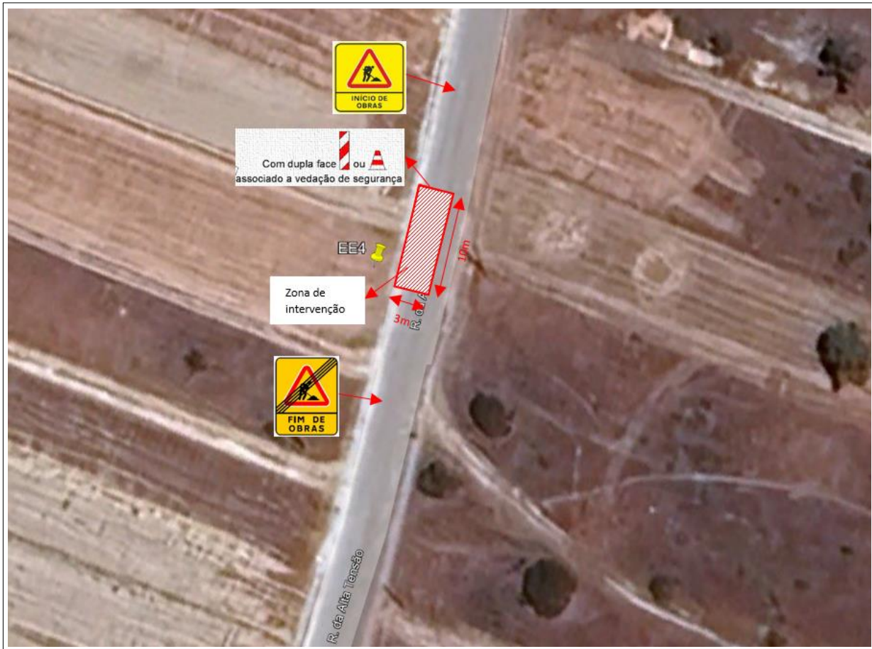
Figura 6 – Esquema representativo da área de intervenção e da sinalização temporária de segurança rodoviária prevista para os ensaios de DPSH na EE4 (sem escala).
