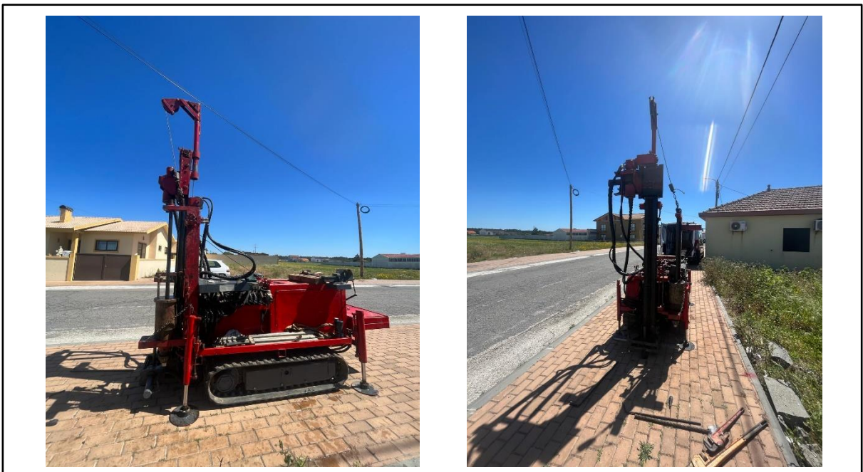
Figura 5 – Fotografias obtidas dos locais dos ensaios de DPSH3 (EE3) e DPSH4 (EE3) (da esquerda para a direita), aquando da execução dos trabalhos de campo (22-04-2024 e 23-04-2024).
