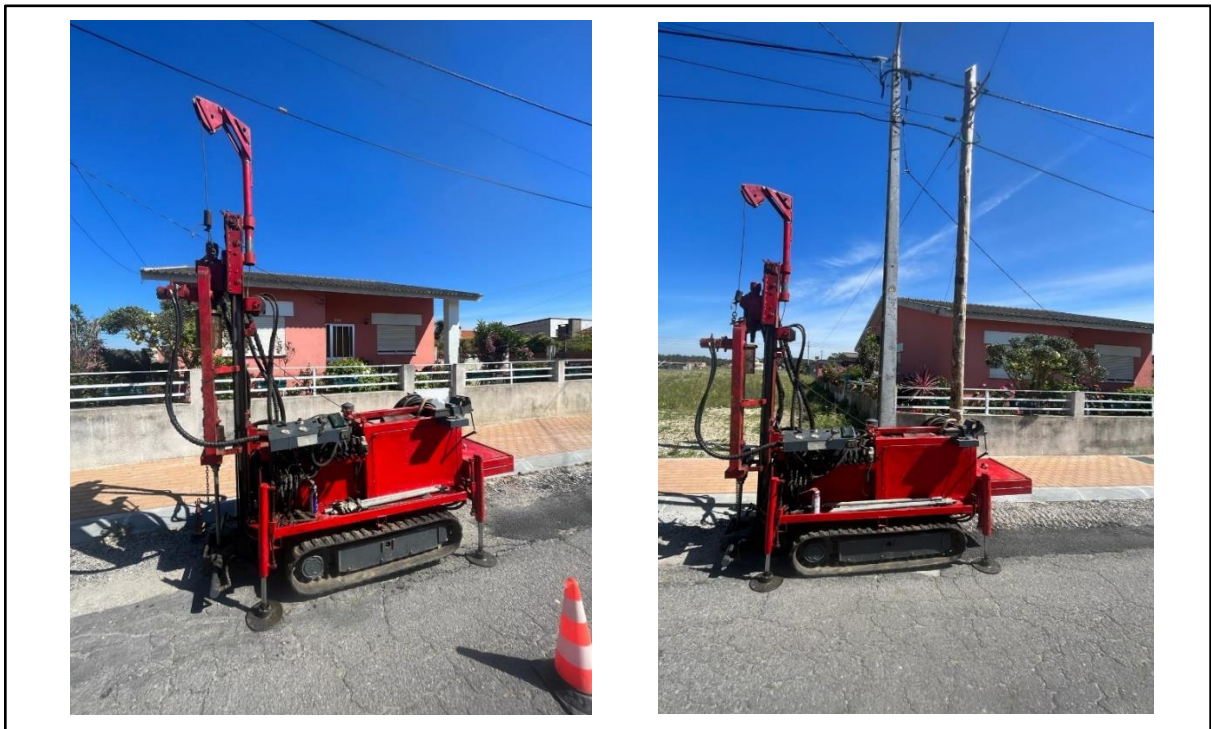
Figura 4 – Fotografias obtidas dos locais dos ensaios de DPSH1 (EE2) e DPSH2 (EE2) (da esquerda para a direita), aquando da execução dos trabalhos de campo (24-04-2024).
