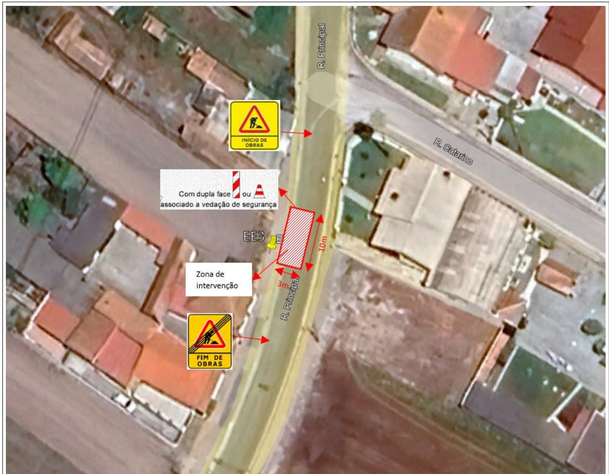
Figura 5 – Esquema representativo da área de intervenção e da sinalização temporária de segurança rodoviária prevista para os ensaios de DPSH na EE3 (sem escala).
