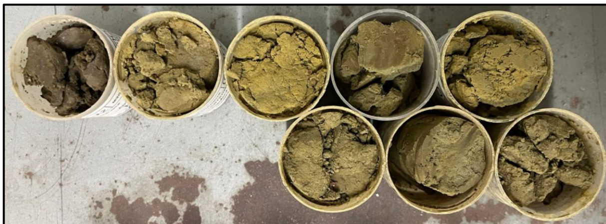
Figura 4: Acondicionamento das amostras colhidas na sondagem S1Cpz .
