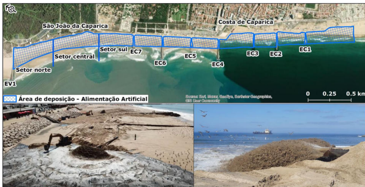
Figura 1 – Área de intervenção da alimentação artificial das praias de São João e Costa de Caparica e aspeto geral dos trabalhos de repulsão na praia em 2019.
