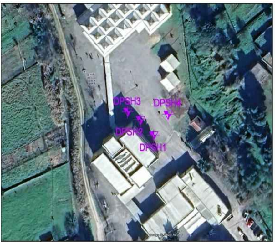
Figura 3 – Identificação e a localização dos elementos de prospeção mecânica realizados (ensaios de DPSH), inserindo sobre imagem obtida do Google Earth (2025).
