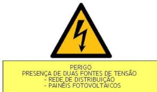
**Figura 2 – Aviso modelo para a presença de duas fontes de tensão.**
