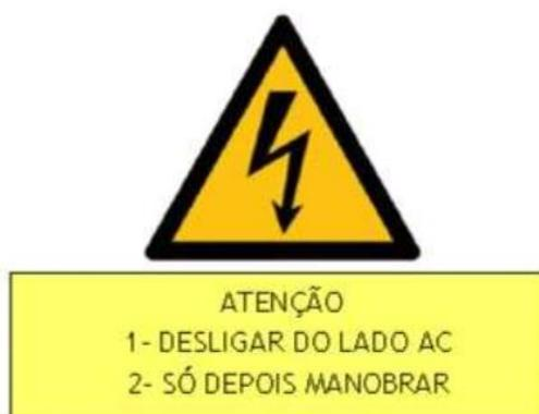
**Figura 3 – Modelo de aviso para o correto desligamento do inversor.**
